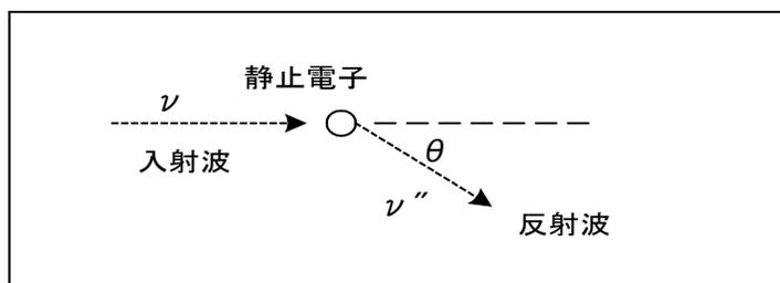
図 2. 静止電子と電磁波の相互作用、入射波の振動数を  $\nu$ 、プランク定数を  $h$ 、電子質量を  $m$ 、光速を  $c$ 、とする。
