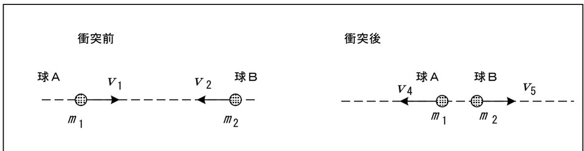
図1. 完全弾性球の衝突を速度について一次の式で解く、2つの弾性球A、Bの質量をそれぞれ  $m_1$ 、 $m_2$  衝突前の速度を  $v_1$ 、 $v_2$  とする。一直線上で衝突し然る後、同じ直線上をそれぞれ反対方向に飛び去る速度をそれぞれ  $v_4$ 、とする。
