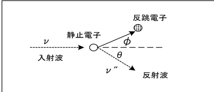
図 4、新しい概念の電子速度と運動量の関係、反射波は $\theta$ 方向に出て反跳電子は $\phi$ 方向に進む、入射波の振動数を $\nu$ 、反射波の振動数 $\nu''$ とする
